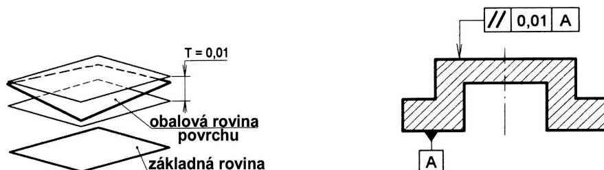
Obrázok č. 5.37, Predpis tolerancie rovnobežnosti
