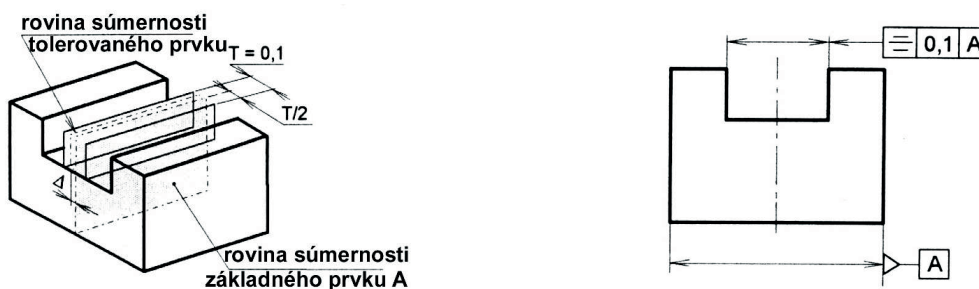
Obrázok č. 5.42, Predpis tolerancie súmernosti
