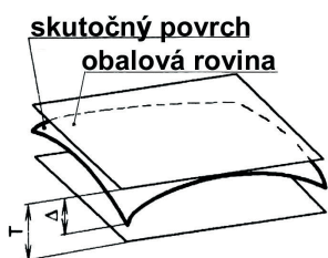
Obrázok č. 5.32, Predpis tolerancie rovinnosti
