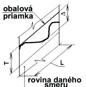
Obrázok č. 5.29, Predpis tolerancie priamosti, tolerančné pole je ohraničené priamkami
