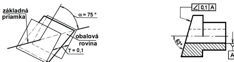
Obrázok č. 5.39, Predpis tolerancie sklonu
