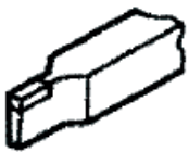
Zapichovací nôž pre hrubovanie rovníramenného lichobežníkového závitu
