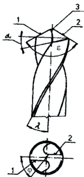
Geometria rezných hrán vrtákov
